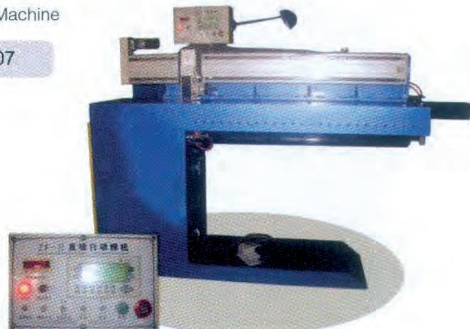
Longitudinal Seam Welding Machine
